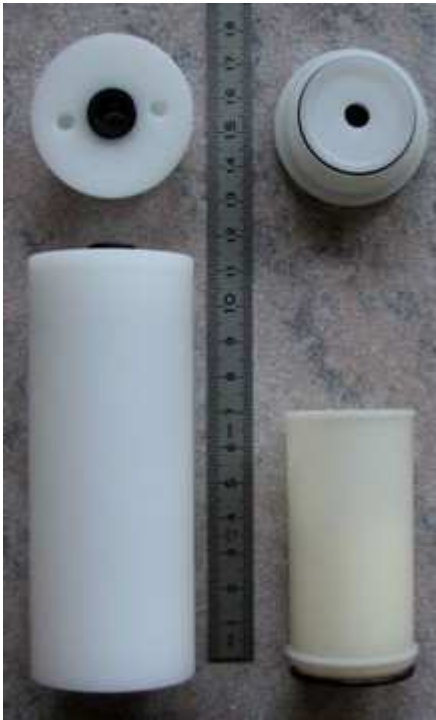
Abb. 1: Gehäuse mit Deckel und Filtermodul.
