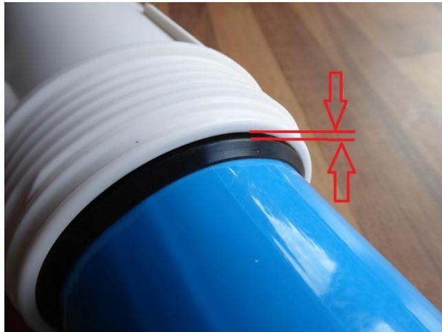
**Folge:** Es kommt hierdurch zu einem Bypass von der Eingangsseite Richtung Konzentrat. Ein Bypass in das Permeat entsteht dadurch zwar nicht, aber es kann zu einer Verschiebung bestimmter Leistungsparameter kommen.
