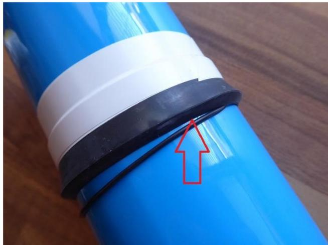
**Abhilfe:** Ein O-Ring oder eine abgeschnittene Endlosdichtschnur passender Schnurstärke wird unter die Lippe geschoben und weitet diese auf. Für ein leichteres Einführen der RO-Membrane kann diese an der Dichtungslippe mit einem trinkwasserzugelassenem O-Ring Fett behandelt werden.
