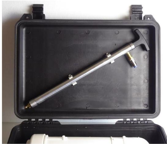
Die HP21 ist hier in einem kompakten, bruchfesten Kunststoffkoffer (Größe Medium 2) auf der Deckelinnenseite eingeklickt. Somit lässt sich alles in einem Koffer unterbringen: Von den Filtern über die Pumpe bis hin zum Ansaugkorb.
