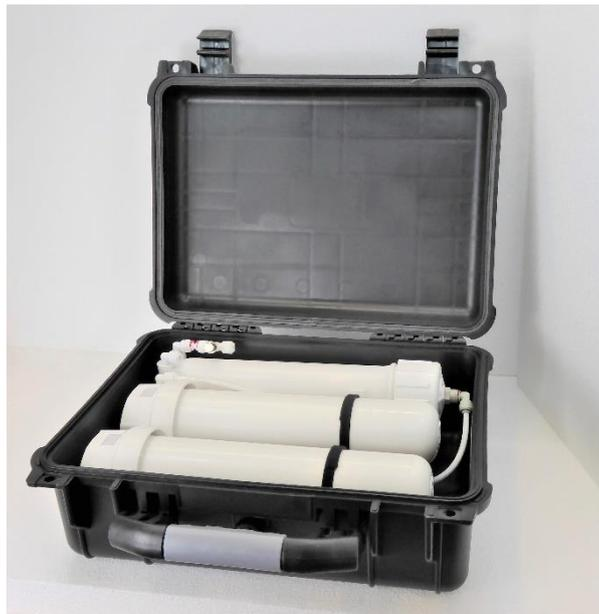
Betrieb eines bruchfesten Koffers mit Vorfiltration, Schadstofffiltration, Keimsperre und optional zuschaltbarer Osmosemembrane.
